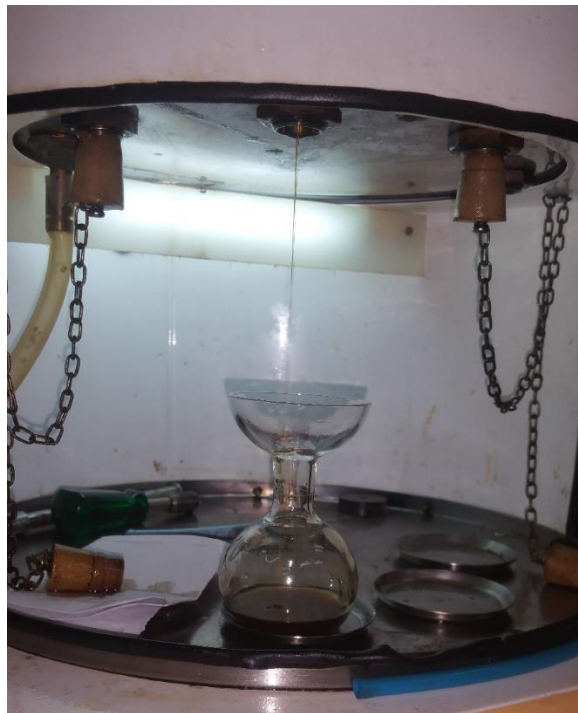
FIGURA 3 – Análise de viscosidade do óleo
